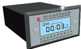
AK04型监控器是整个AR60润滑系统的控制中枢，动态显示油路油压、休止倒计时、运行计时、累计工作次数及故障代码等运行参数，并具有过载保护和故障报警功能。适合DC24V电源，安装于驾驶室便于司机观看的位置。为便于系统维修，监控器配置有遥控器。
