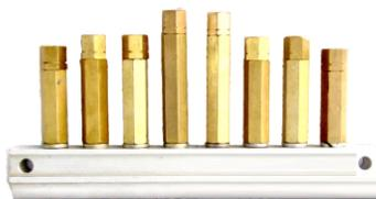
单列式单线分配器排油压力来自主油管路油压，常温下最大排油压力可达3.0MPa,低温环境下排油压力自动随气温下降而提高。润滑泵停止工作后，分油器储油腔计量储油。
